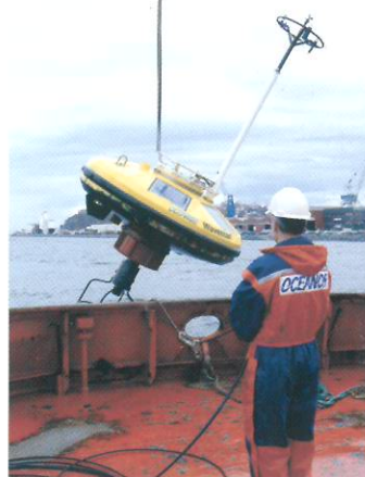
La bouée d'enregistrement de mesures des océans est fabriquée à Trondheim. © Company Fugro Oceanor
